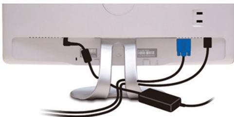
Verwenden Sie nach dem Anschließen aller erforderlichen Kabel an Ihren Monitor und den Computer (siehe [Anschließen des Monitors](#)) die Kabelführungsöffnung, um sämtliche Kabel wie oben abgebildet sauber zu verlegen.
